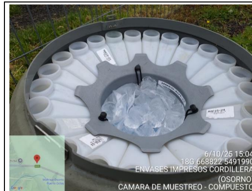
Fotografía 2: Carga de hielo Equipo Automático
